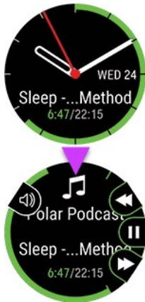
음악 제어 위치 화면에서, 그리고 트레이닝을 하지 않을 때 휴대폰에서 음악 및 미디어 재생을 제어 할 수 있습니다. OK(확인) 버튼을 눌러 이전/다음 및 일시 중지/재생 버튼을 봅니다. UP/DOWN(위로/아래로) 버튼으로 이전 또는 다음 곡으로 전환하고 OK(확인) 버튼으로 일시 중지합니다. LIGHT(라이트) 버튼을 눌러 볼륨 제어에 액세스합니다.
