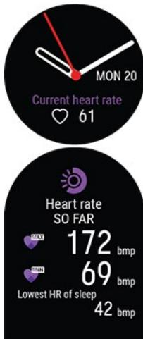
기능이 켜지면 워치가 지속적으로 심박수를 측정하여 심박수 워치 화면에 표시합니다. 상세 정보를 열면 하루 중의 최고 및 최저 심박수 측정값을 확인할 수도 있고 전날 밤의 최저 심박수 측정값을 확인할 수도 있습니다.
