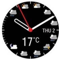
その日の1時間ごとの予報を直接腕時計上に表示します。OKボタンを押すと、風速、風の方向、湿度、降水確率、明日の3時間予報、および明後日の6時間予報などを含むより詳細にわたる天候情報を表示することができます。
