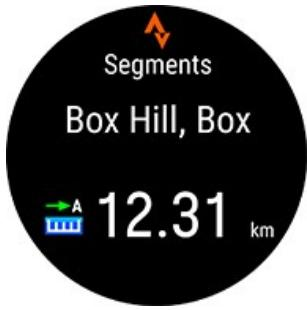
セグメント(サイクリングでは200メートル以内、ランニングでは100メートル以内)に近づくと、腕時計にアラートを受け取り、セグメントまでの残りの距離がカウントダウンされます。腕時計のBACKボタンを押してセグメントをキャンセルできます。
