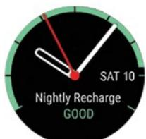
起床時に睡眠の詳細に Nightly Recharge 画面表示を介してアクセスできます。OKボタンを押して、Nightly Rechargeステータス詳細を開き、次に、DOWN(右下)ボタンで「睡眠ステータス詳細」まで下にスクロールします。OKボタンを押して詳細を開きます。
