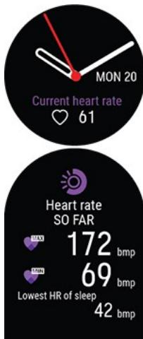
継続的な心拍計測機能をオンにすると、腕時計は継続的に心拍数を測定し、それを心拍数画面で表示します。詳細を開くと、その日の最高心拍数と最低心拍数、また前夜の最低心拍数が確認できます。
