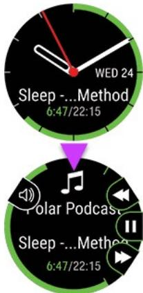
トレーニングをしていない時は腕時計の音楽コントロール表示画面から、スマートフォン上で再生中の音楽とメディアを調整できます。OKボタンを押すと、前へ/次へ、一時停止/再生ボタンが表示されます。UP(右上)ボタンとDOWN(右下)ボタンを使って前の曲、次の曲に切り替えます。一時停止したい時はOKボタンを押します。LIGHT(左上)ボタンをタップして音量を調整します。
