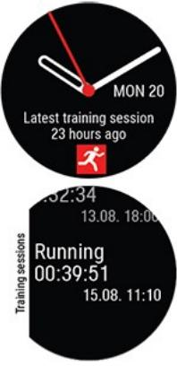
時刻表示画面で、UP(右上)ボタンおよびDOWN(右下)ボタンを使用して、**最新のトレーニング セッション**画面表示に移動し、OKボタンを押します。
