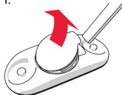
1. Abra a tampa da pilha usando uma ferramenta pequena de ponta chata. (imagem 1)
