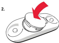
4. Alinhe a borda na tampa da pilha com a ranhura no conector e pressione a tampa da pilha de volta no lugar (imagem 2). Deverá ouvir o som de encaixe.
