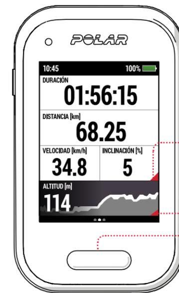
El triángulo rojo te indica que puedes cambiar rápidamente la información mostrada, por ejemplo ir de velocidad a velocidad media.
