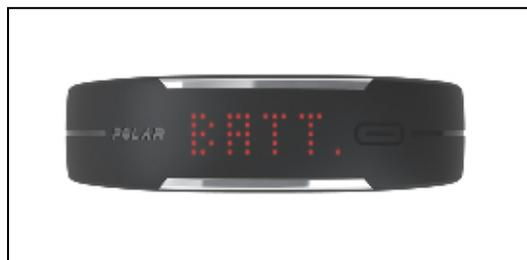
**БАТ. LOW** отображается при низком уровне заряда аккумулятора. Его необходимо зарядить в течение ближайших 24 часов.
