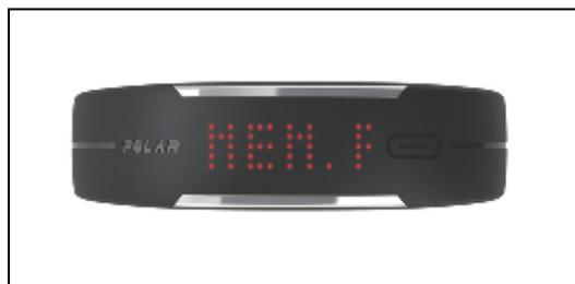
**MEM. FULL** отображается, когда занято 80% памяти Polar Loop 2. Синхронизируйте свои данные об активности с онлайн-сервисом Polar Flow через USB-шнур или приложение для мобильных устройств Polar Flow. На Polar Loop 2 данные об активности могут храниться до 12 дней. Как только память устройства заполнена, самые старые данные заменяются самыми новыми.
