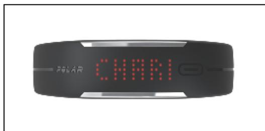
Сообщение **CHARGE** отображается, когда аккумулятор почти полностью разряжен. Светодиодные лампочки гаснут. Пока вы не зарядите датчик частоты сердечных сокращений, вы не сможете использовать его с приложением для мобильных устройств Polar Flow и с Polar Loop 2.
