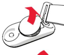
1. Abre la tapa de la pila haciendo palanca con el clip de la correa.
